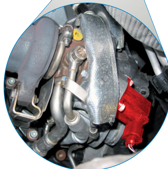
Válvula de aire circulante en régimen de retención en el VW EOS TFSI (destacada en rojo)
